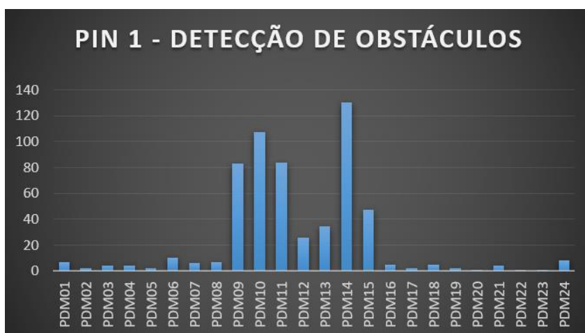
FIGURA 9 – Recorrência de detecção de obstáculos na plataforma 01 da estação Pinheiros.
