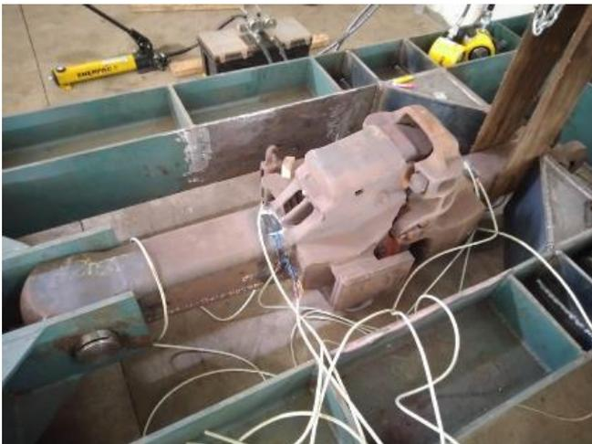
**Figura 7 – Extensômetros instalados no engate durante calibração.**
