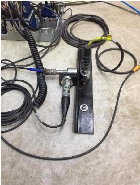
**Figura 4 – Acelerômetros instalados no piso do carro de passageiros.**
