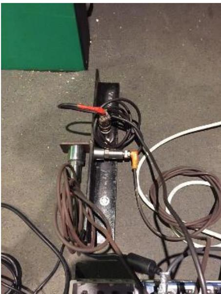
**Figura 5 - Acelerômetros instalados no piso do carro ambiental.**
