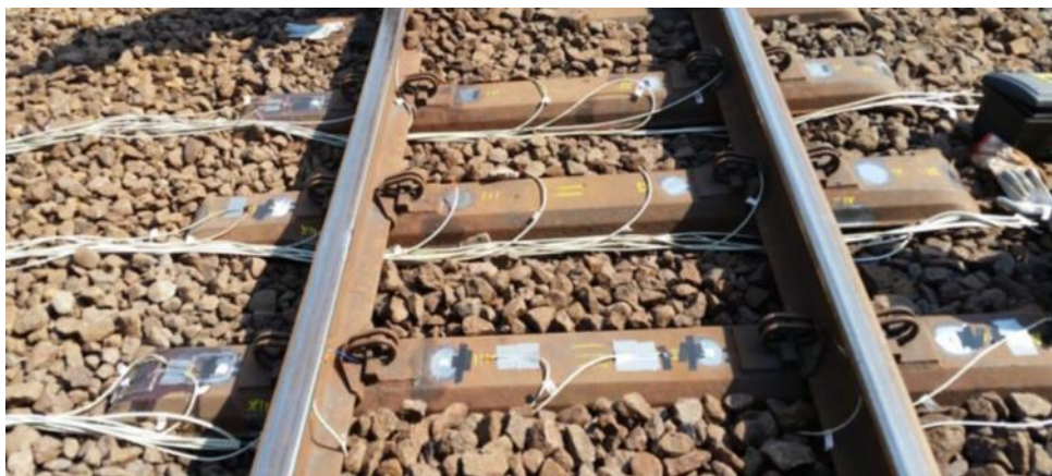
Figura 7 – Instrumentação de dormentes realizadas na EFVM pela empresa KOT em 2017. (Kotchergenken Engenharia Ltda, 2017)
