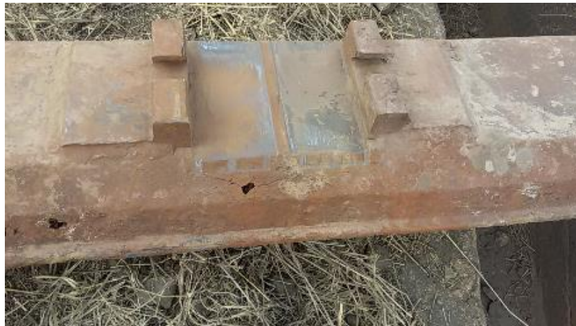
Figura 2 - Dormente trincado com corrosão. Ano de Fabricação 1987.
