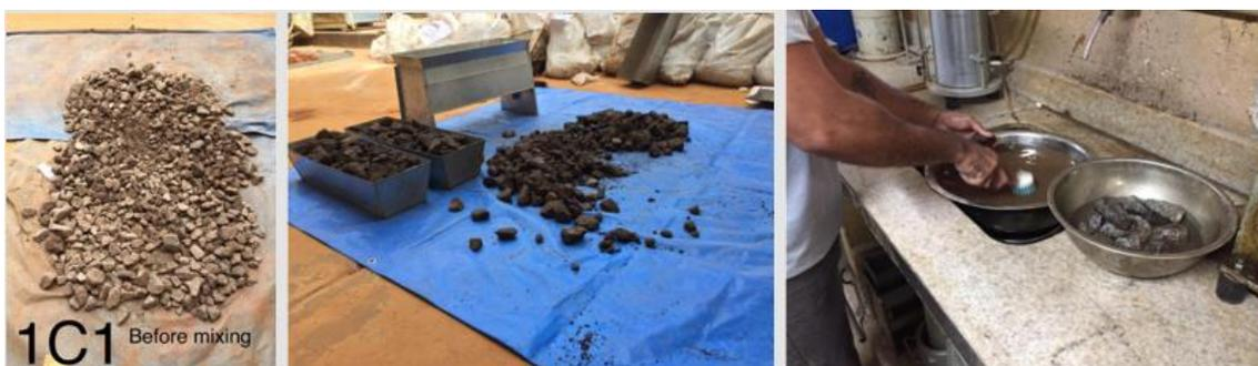
**Figura 11 – Ensaio laboratorial de lastro realizado no método tradicional para obter o índice de contaminação do lastro**
