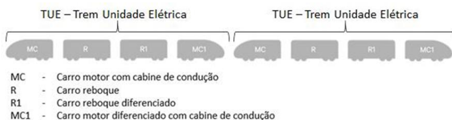
Figura 4 - Composição do Material Rodante série 7000
