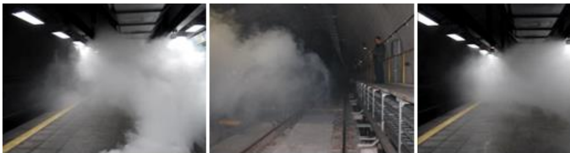
Figura 3- O sistema de Ventilação deverá ser capaz de controlar a fumaça na estação e túneis em caso de incêndio
