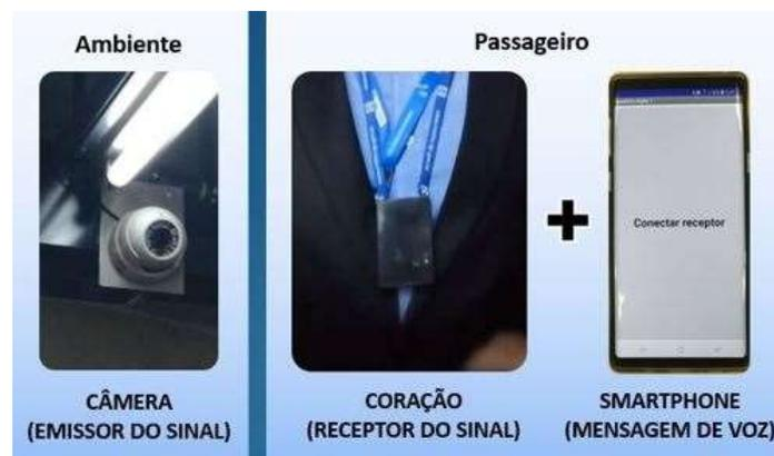
**Figura 1 – Componentes do sistema SigaFácil: câmeras, coração e smartphone**
