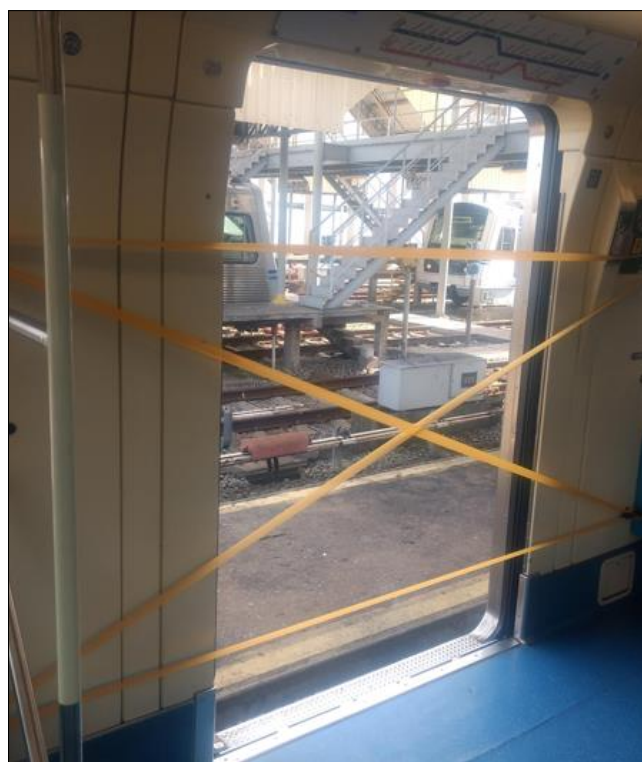
Figura 5 - Novo cinturão utilizado para sinalização de porta emperrada aberta.
