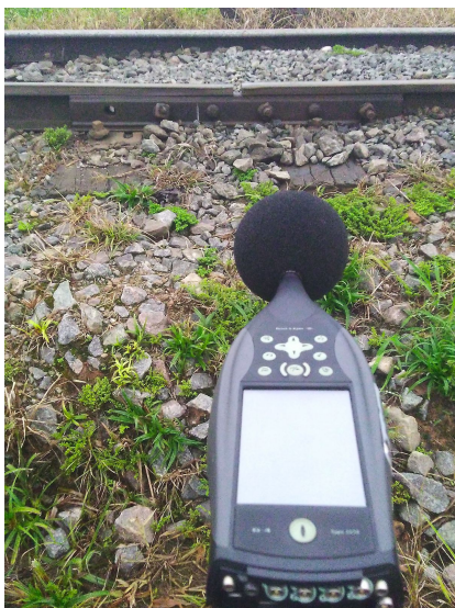
Figura 4 – Medidor de nível de pressão sonora posicionado próximo da junta em degrau
