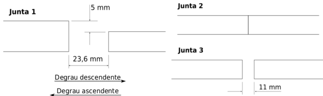
Figura 3 – Geometria das juntas estudadas
